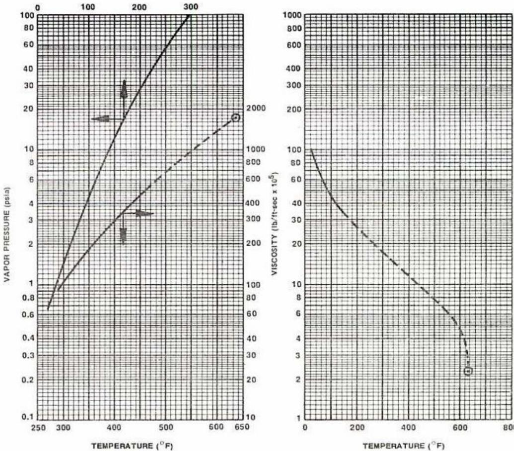
PHYSICAL PROPERTIES OF AEROZINE-50: 50% N<sub>2</sub>H<sub>4</sub> – 50% UDMH, b.w.
